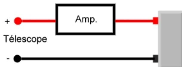
Et oui, ils en consomment! J'ai pris ma monture CG5 GoTo, et je l'ai branchée sur un accumulateur 12V 6,5Ah et en série entre la monture et celui-ci, un amplificateur-motor à cadre mobile, (Un contrôleur universel numérique convient aussi).
