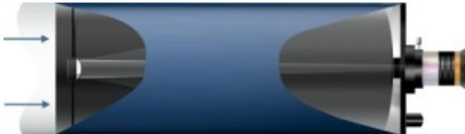
Cette configuration de t lescope   l'avantage de rallonger sa focale par rapport   un Newton!
